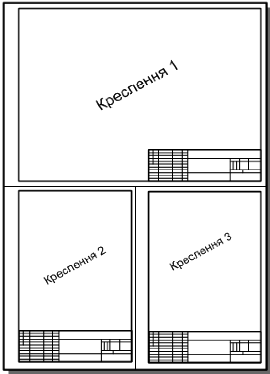
Рисунок 5.2 – Порядок розміщення кількох креслень на одному аркуші формату А1
